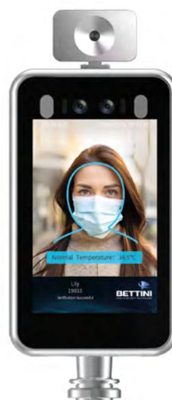
La prima verifica effettuata sulla persona che deve accedere al varco è la misura della temperatura corporea, fatta in automatico tramite la funzione di face detection: se il valore misurato non supera la soglia di  $37,5^{\circ}\text{C}$ , il dispositivo FRT-B8 procede a controllare se la persona indossa la mascherina protettiva o meno; il terzo criterio, quando necessario, è la verifica del volto con riscontro nella lista di persone autorizzate all'ingresso.
